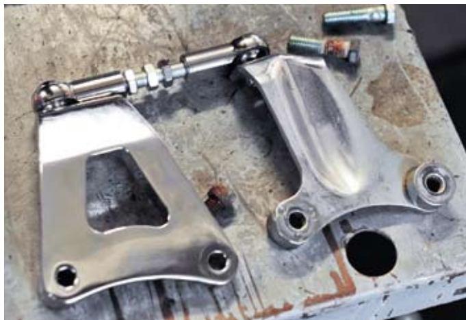
Jim's-fästet ser inte så lite starkare och elegantare ut än originalfästet.
