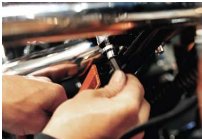
En svets på ramen gör att en bult inte går i som den ska.
